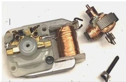
Märklin - Motor mit 3 poligen Anker
